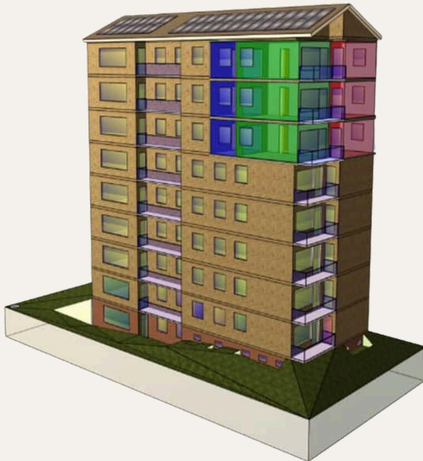
Nach der Ermittlung der raumweisen Heizlasten werden nun die bestehenden Heizkörper oder Fußbodenheizkreisläufe den einzelnen Raumwerten zugeteilt und in Abhängigkeit zur Heizungs- bzw. Pumpenentfernung und den jeweiligem Rohrquerschnitten die einzelnen Warmwasservolumenströme ermittelt.
